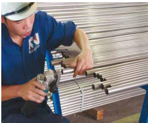
Hình 3: Công nhân mài đầu ống
